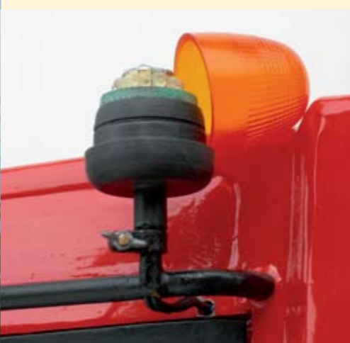
Die gestielte Version mit runder Haube, die Flügelschraube gehört nicht zum Lieferumfang
